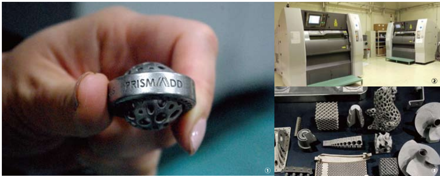
① ProX DMP 300 で出力した PRISMADD ロゴマークの試作品 ② プリズマット・ジャパン工場内の ProX DMP 300 (2台) 設置状況 ③ ProX DMP 300 で出力したさまざまな造形物
