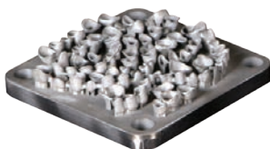
コバルトクロム (CoCr) での パーシャル、コーピング、ブ リッジ製作
