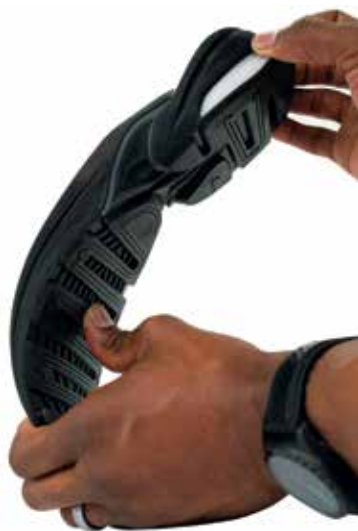
柔軟性のあるブラックエラストマーと、硬質白のプラスチックでプリントした靴のソール
